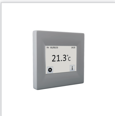
Termostat TFT – do sterowania ogrzewaniem podłogowym i sufitowym z ekranem dotykowym. Posiada 7 programów do regulacji temperatury, histereza 0,5°C. Moc przełączeniowa [W]: do 3500.
